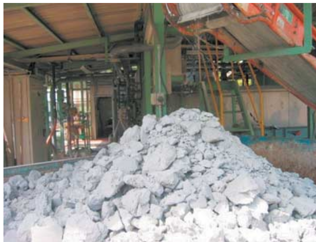
排水処理場の脱水汚泥
